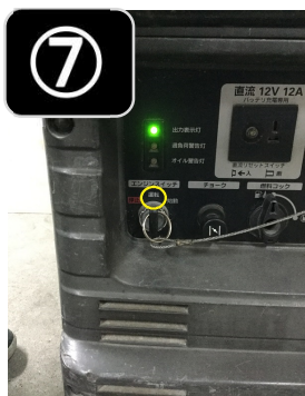
始動が始まるとスイッチが「運転」に切り替わる
