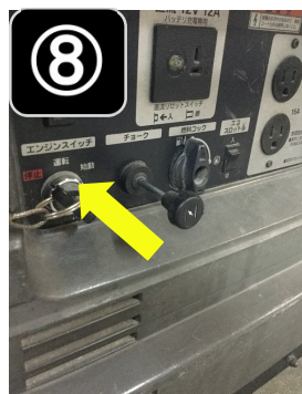
エンジンの回転が落ち着いたらチョークレバーを押して元の位置へ徐々に戻す
