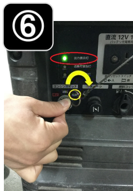
スイッチを矢印の運転の方向へ長めに回すと出力表示灯(緑)が点灯
