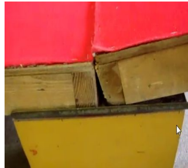
↑ 金具部材の溝に天板をはめ込みます。
